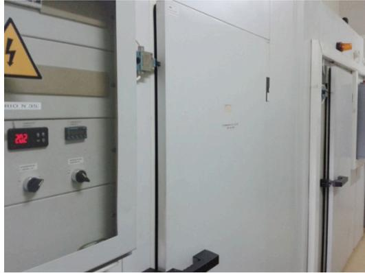
**Figura 3.3.1.** Detalle de la cámara con temperatura controlada
