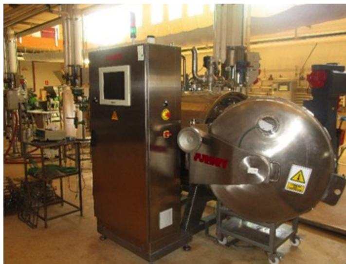
**Figura 2.1.3.** Detalle del autoclave piloto empleado en la pasterización de aceitunas
