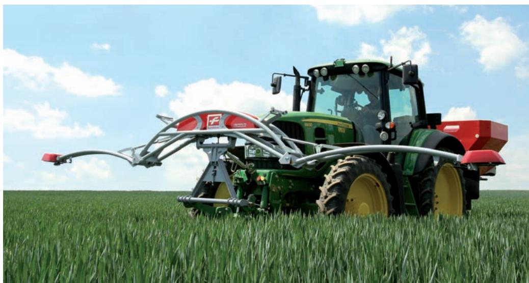
Figura 4. Abonado nitrogenado con máquina VRT basada en sensor óptico (Cortesía de Fritzmeier Umwelttechnik)
