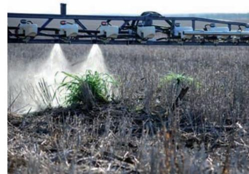
Figura 5. Aplicación selectiva de herbicida mediante sensores ópticos que detectan las malas hierbas (Weed Seeker de Trimble).
