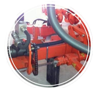
Figura 15. Válvula de control de flujo y motor hidráulico de velocidad variable
