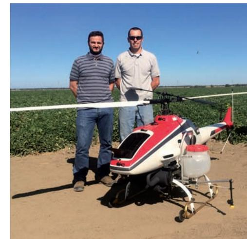
Figura 8. Helicóptero de 3 m de envergadura para aplicaciones de pesticidas (Fuente: UC Davis News).
