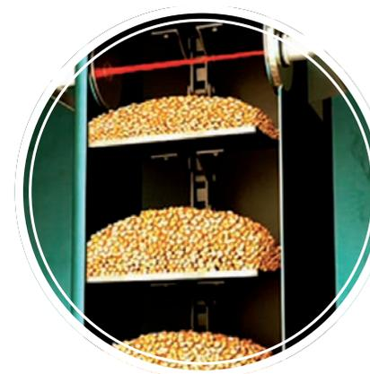
Figura 10. Fotoemisor y fotosensor integrado en el conducto de canchales para cuantificar el flujo de cosecha.
