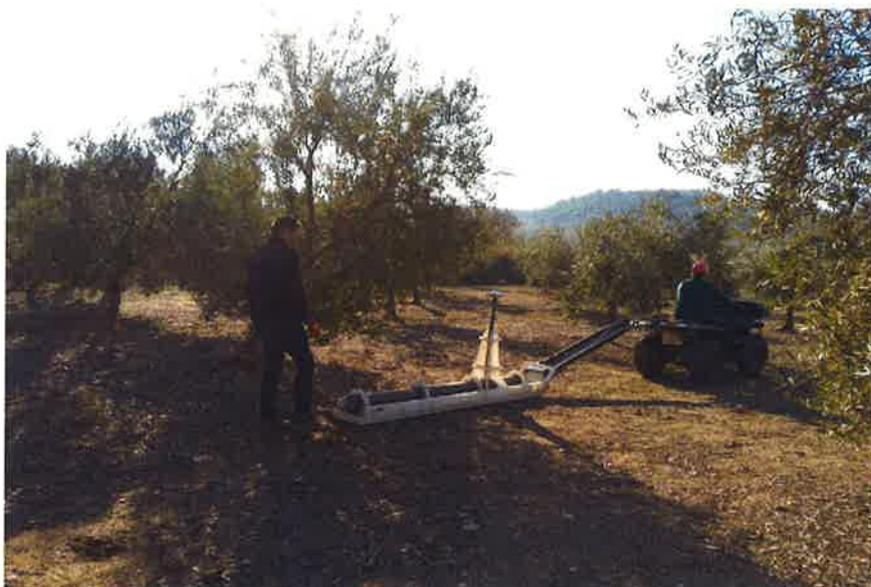
Imagen sensor Dualem acoplado a Quad en la parcela F5
