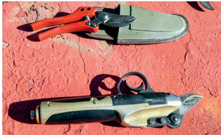
En la actualidad hay muchas otras herramientas que se utilizan para podar y que incluso han sustituido las tradicionales. Por ejemplo, la calaboz ha sido sustituida por pequeñas sierras, muchas veces mecánicas y otras montadas sobre pértigas, que permiten cortar con facilidad ramos y ramas, incluso las que estén en puntos altos. Las antiguas tijeras se sustituyen por unas que funcionan con batería y con las que las manos no tienen que hacer ningún esfuerzo de prensión.
